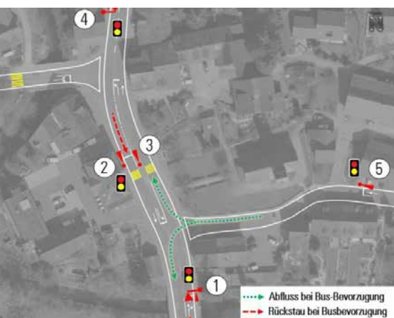
Bestvariante der Busbevorzugungsanlage. [TBA ZH, 15.01.2026]
