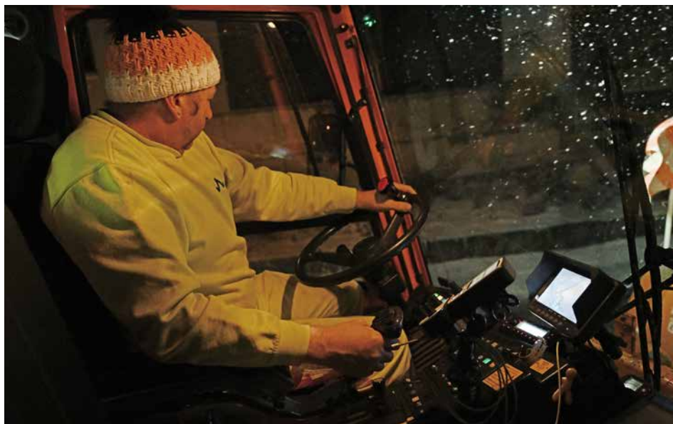
Höchste Konzentration: Während Rolf Walter mit dem Räumfahrzeug unterwegs ist, muss er auch die Kamera am hinteren Ende des Fahrzeuges und die Salzsteuerung im Auge behalten.
